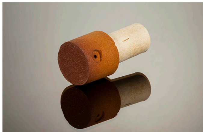
نمونه بردار TKP برای نمونه چدن سفید، طبق استاندارد (E) 4284-1996
